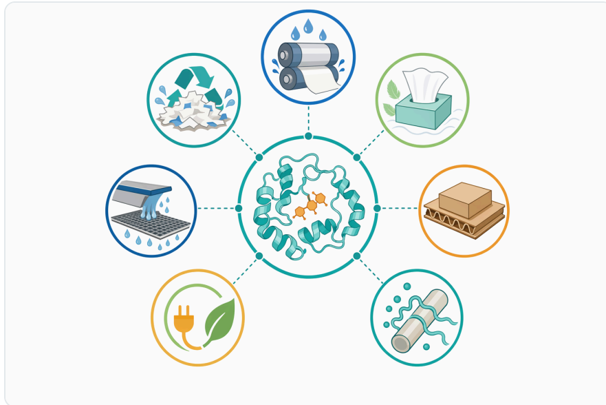
Figure 5. 제지 및 펄프 분야에서 셀룰라아제의 응용에는 탈묵, 백수 내 미세분 제어, 배수성 개선 지원, 고해 보조제 활용, 바이오표백 지원, 나노셀룰로오스 생산, 슬러지 자원화가 포함된다.
