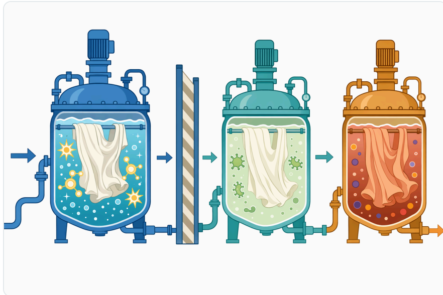
Figure 8. 카탈라아제는 과산화물 표백이 완료된 후 사용해야 합니다. 너무 일찍 투입하면 표백에 필요한 산화제를 제거하게 됩니다.
