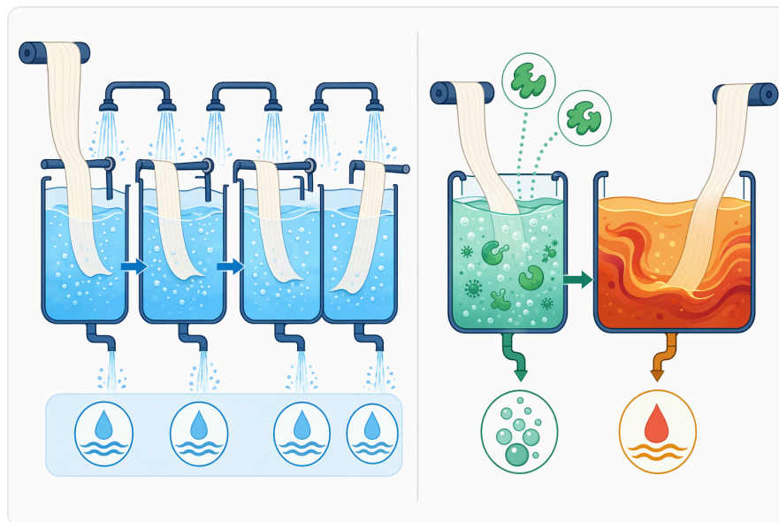
Figure 6. 카탈라아제는 과산화수소를 직접 분해함으로써, 과산화수소 제거가 장시간 세척의 주된 이유인 경우 반복적인 수세만으로 제거하는 방식에 대한 의존도를 줄일 수 있다.
