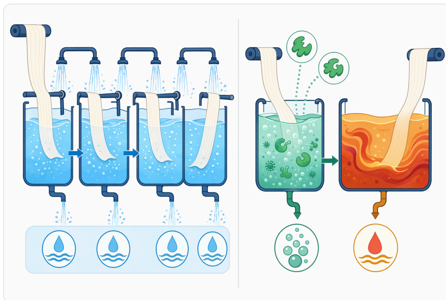
Figure 6. 카탈라아제는 과산화수소를 직접 분해함으로써, 과산화수소가 장시간 세척의 주된 원인인 경우 반복적인 수세만으로 제거하는 방식에 대한 의존을 줄일 수 있다.
