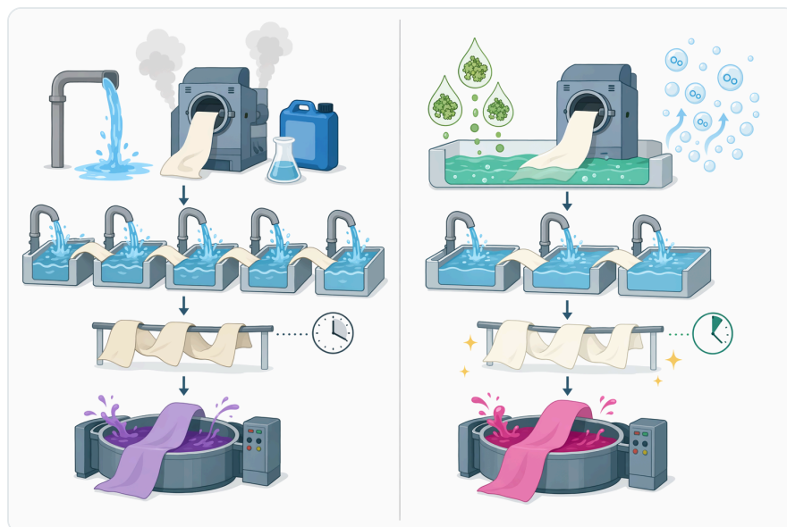
Figure 4. 반복 세척이나 화학적 환원에 비해 카탈라아제는 더 온화한 조건에서 물 사용량을 줄이고 처리 시간을 단축하면서 과산화수소를 제거합니다.
