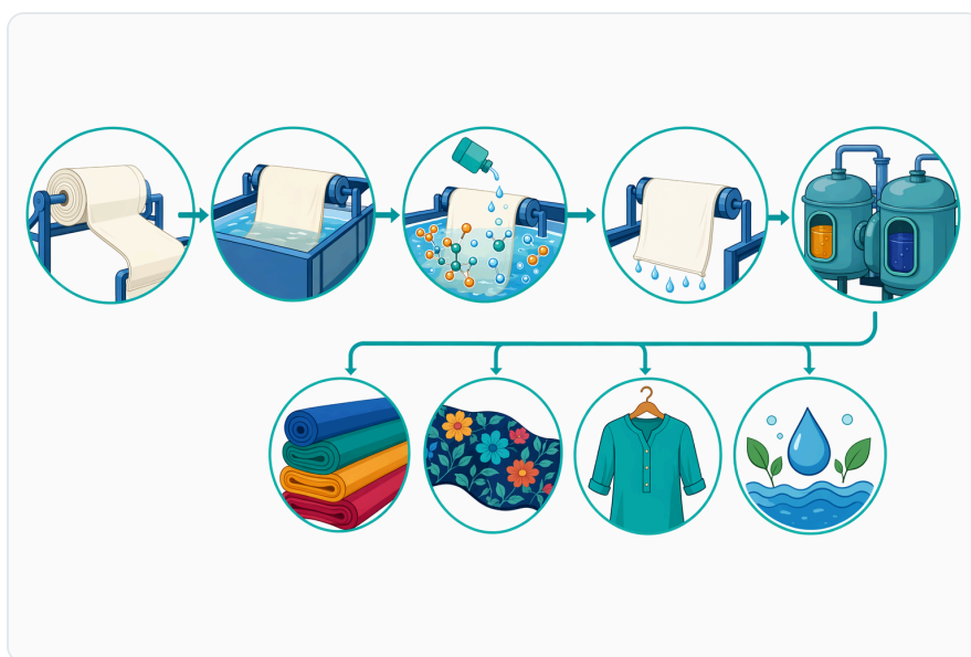
Figure 2. 섬유 가공에서는 과산화물 표백 후 염색이나 후가공 전에 잔류 산화제를 제거하기 위해 액상 카탈라아제를 첨가합니다.
