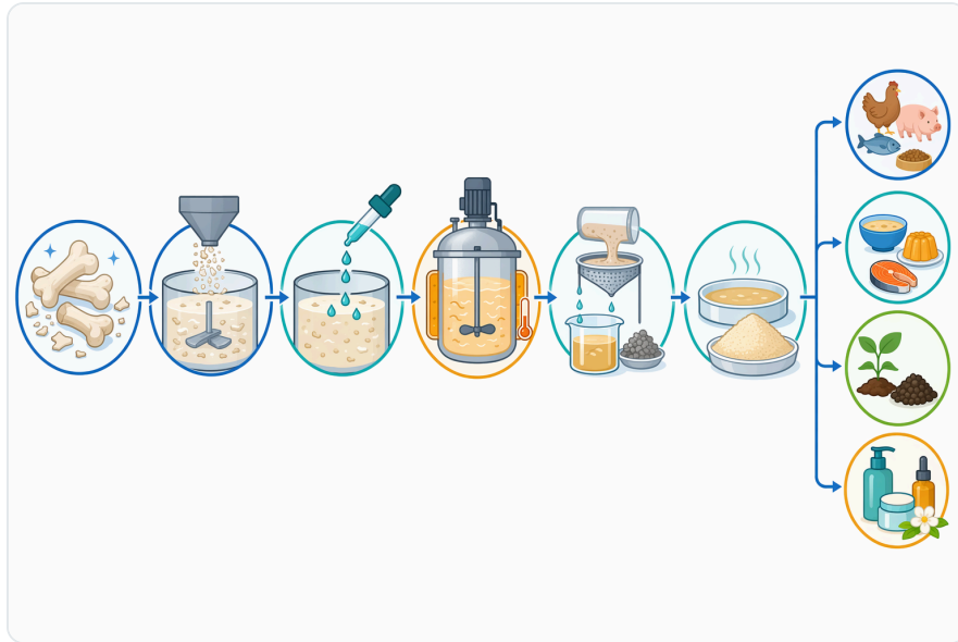
Figure 3. 基質前處理步驟，如縮小粒徑、控制加熱、脫脂，以及選擇性脫礦，可提升骨蛋白對蛋白酶作用的可及性。
