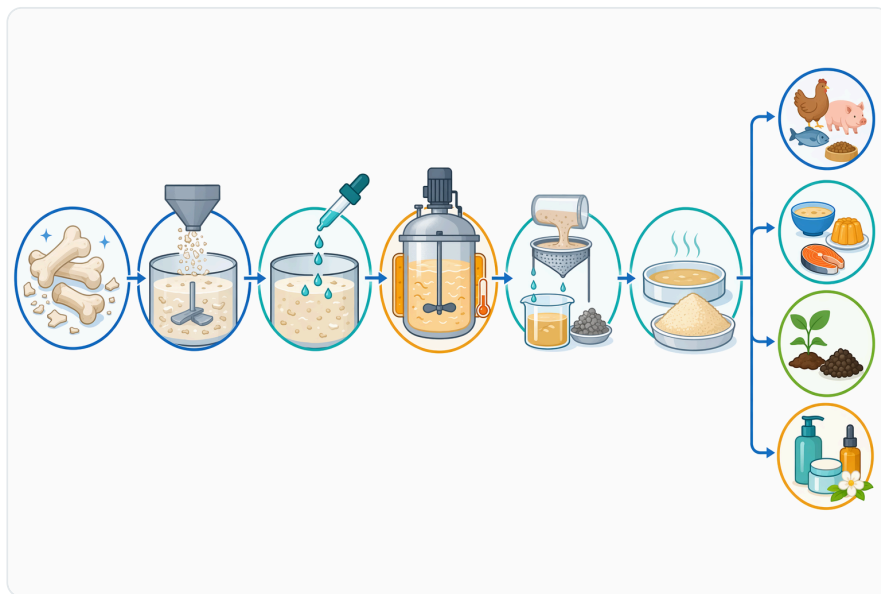
Figure 3. 입자 크기 축소, 가열 조절, 탈지, 선택적 탈회와 같은 기질 전처리 단계는 뼈 단백질이 프로테아제 작용을 더 잘 받을 수 있도록 접근성을 높인다.
