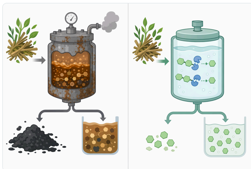
Figure 4. 산 가수분해와 비교해 베타-글루코시다아제를 이용한 공정은 더 온화한 조건에서 이루어지며, 셀로비오스를 전환해 포도당 수율을 향상시킵니다.
