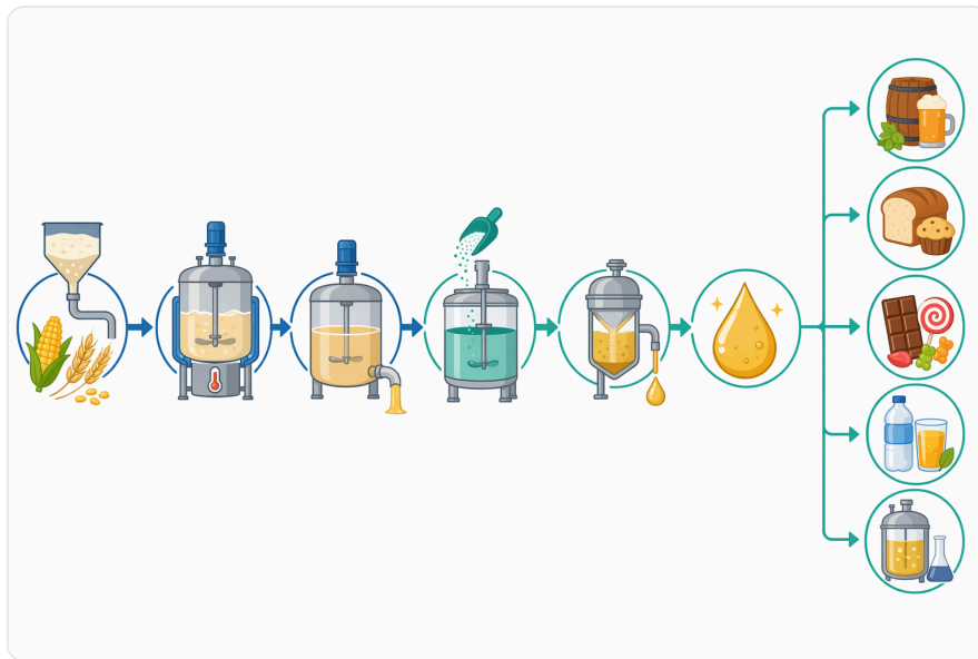
Figure 6. 在釀酒與蒸餾製程中，澱粉開放、 \alpha -澱粉酶液化、 \beta -澱粉酶形成麥芽糖，以及酵母發酵，構成相互連結的製程階段。
