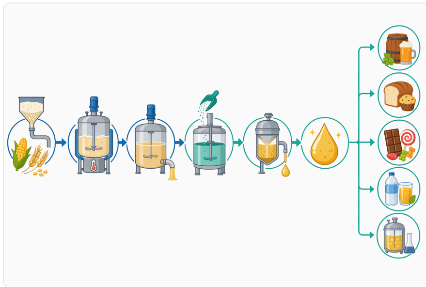
Figure 6. 양조와 증류에서는 전분의 개방, 알파-아밀레이스에 의한 액화, 베타-아밀레이스에 의한 말토스 형성, 효모 발효가 서로 연결된 공정 단계로 작용한다.
