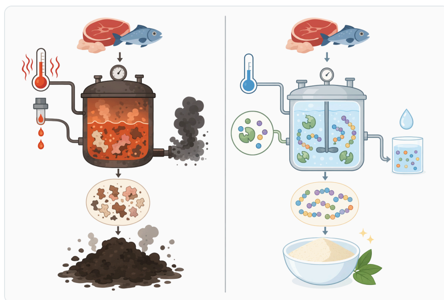
Figure 4. 가혹한 화학적 가수분해와 비교할 때, 아미노펩티다아제 처리는 더 온화하고 선택적인 단백질 가수분해를 제공하여 제품 품질을 향상시킵니다.
