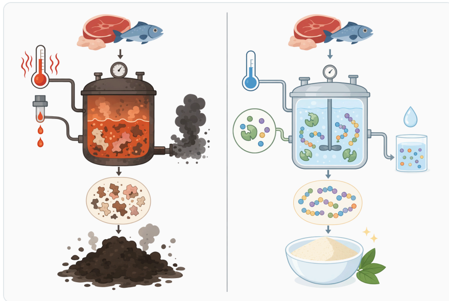
Figure 4. 강한 조건의 화학적 가수분해와 비교할 때, 아미노펩티다아제 처리는 더 온화하고 선택적인 단백질 가수분해를 제공하여 제품 품질을 향상시킵니다.
