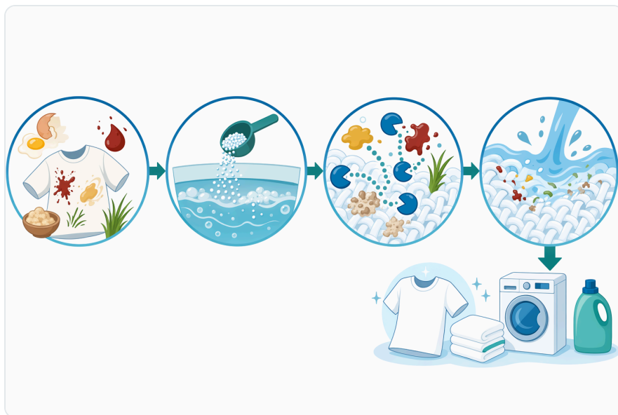
Figure 2. 在洗滌劑流程中，會將鹼性蛋白酶加入洗液中，以分解蛋白質污垢，並在中等溫度下提升去漬效果。
