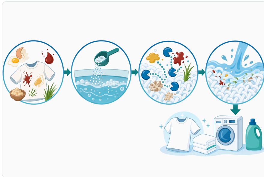
Figure 2. 세제 공정에서는 알칼리성 프로테아제를 세탁액에 투입해 단백질성 오염을 분해하고, 중간 정도의 온도에서도 얼룩이 더 잘 떨어지도록 합니다.
