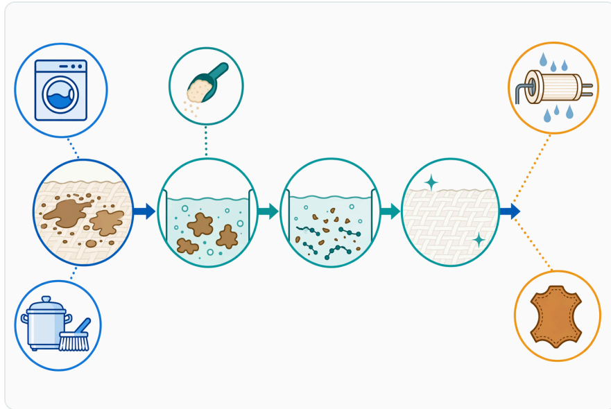
Figure 3. 단백질 막 제거는 효소가 접촉해 펩타이드 결합을 절단하는 단계에서 시작해, 막 구조가 약해지고 조각들이 분산된 뒤 헹굼 과정에서 제거되는 순서로 진행됩니다
