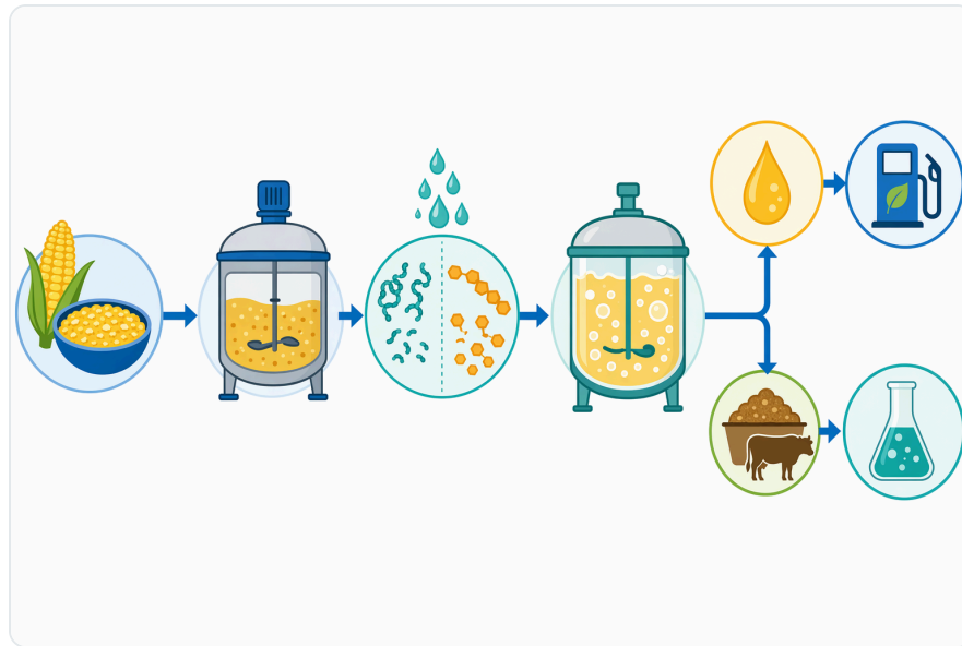
Figure 1. 酸性蛋白酶可将穀物蛋白質轉化為酵母可利用的氮源，同時澱粉酶生成可發酵糖，從而支持澱粉乙醇發酵。
