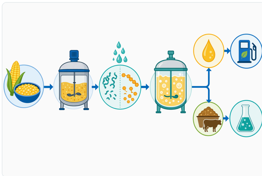
Figure 1. 산성 프로테아제는 곡물 단백질을 효모가 이용할 수 있는 질소원으로 전환하고, 전분 효소는 발효 가능한 당을 생성하여 전분 기반 에탄올 발효를 돕습니다.
