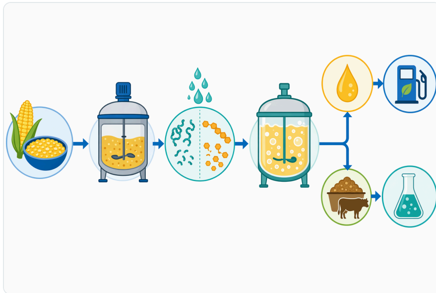
Figure 1. 산성 프로테아제는 곡물 단백질을 효모가 이용할 수 있는 질소원으로 전환하고, 전분 효소는 발효 가능한 당을 생성함으로써 전분 기반 에탄올 발효를 돕습니다.
