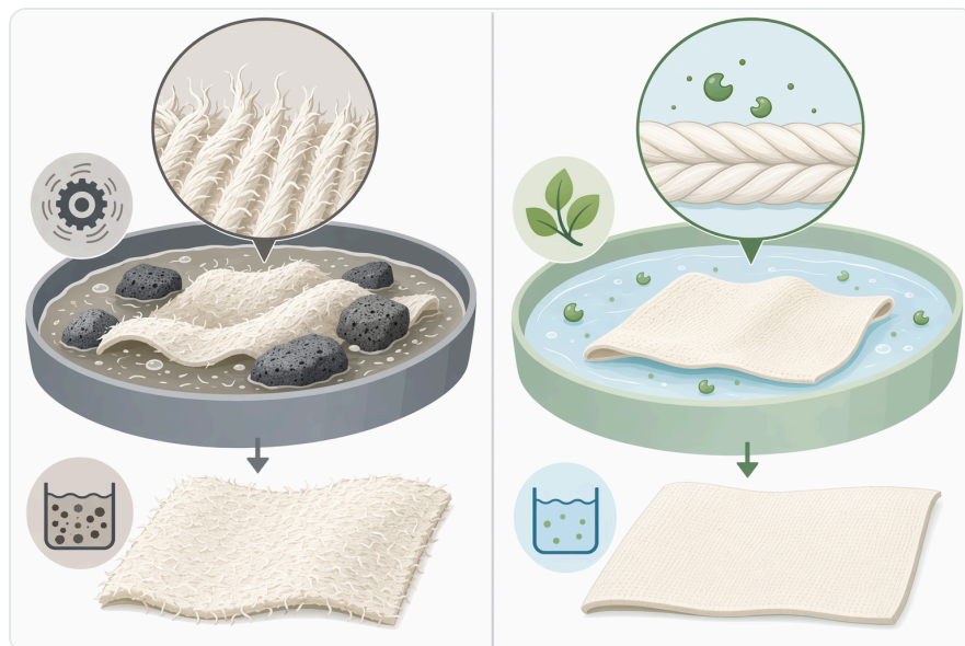
Figure 4. 酸性、中性與鹼性纖維素酶都具有水解纖維素的機制，但在實際製程所適用的 pH 條件與紡織整理效果上有所不同。
