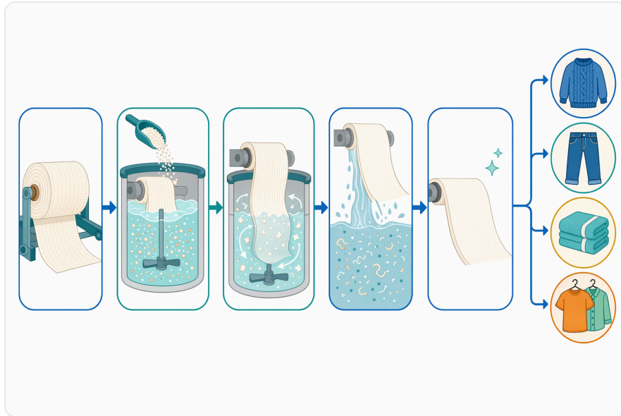
Figure 2. 바이오 폴리싱은 표면 피브릴을 효소로 약화시키고, 습식 가공 중의 움직임으로 느슨해진 셀룰로오스 조각을 떨어져 나가게 하는 공정이다.
