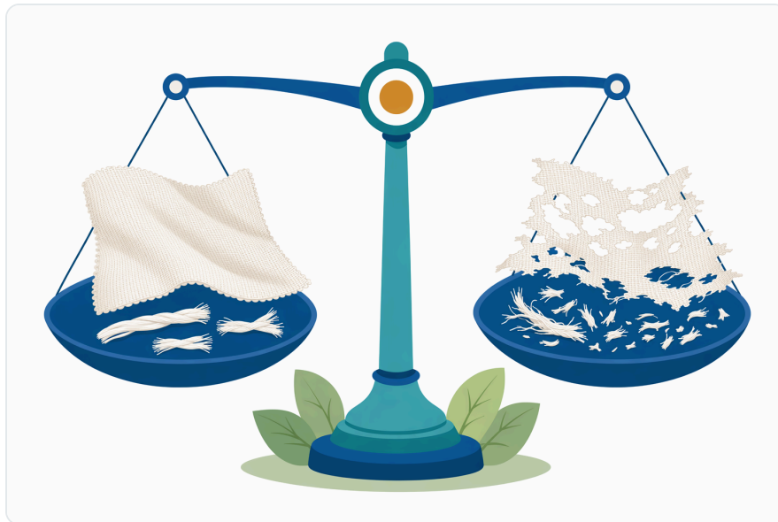
Figure 6. 매끄러움을 개선하는 동일한 셀룰로오스 가수분해도 의도한 표면 효과를 넘어 반응이 계속되면 중량 감소나 강도 저하를 일으킬 수 있다.
