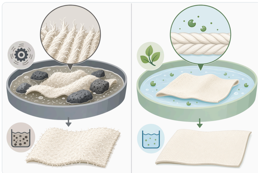
Figure 4. 산성, 중성, 알칼리성 셀룰라아제는 모두 셀룰로오스를 가수분해하는 메커니즘을 공유하지만, 실제 공정에 적합한 pH 범위와 섬유 마감 특성은 서로 다르다.
