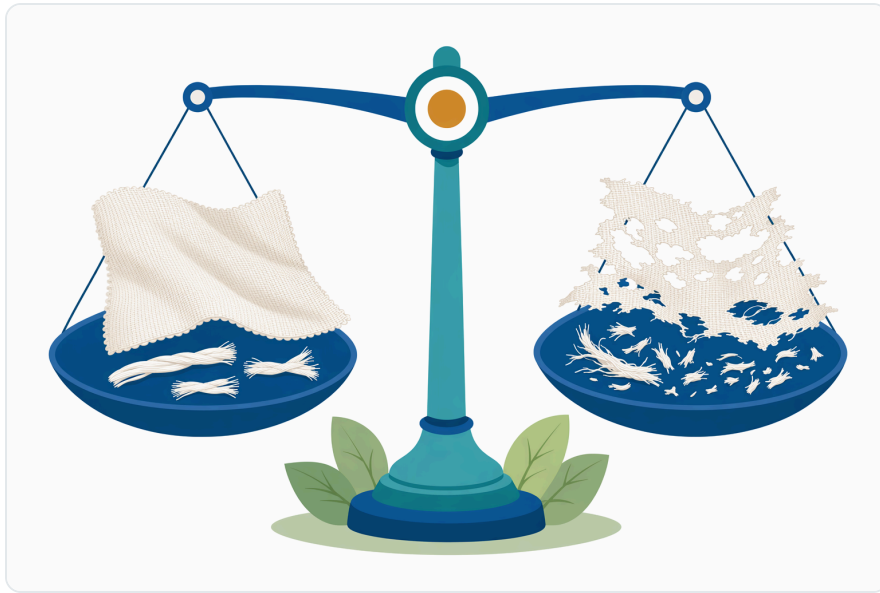
Figure 6. 표면을 더 매끄럽게 만드는 동일한 셀룰로오스 가수분해 반응도의 도한 표면 효과를 넘어 계속 진행되면 중량 감소나 강도 저하를 일으킬 수 있습니다.
