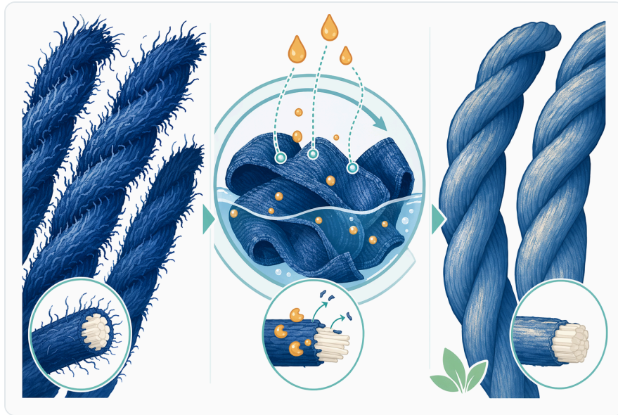
Figure 6. 在丹寧布與棉織物整理中，若處理受到控制，酸性纖維素酶主要作用於暴露在表面的細纖維。
