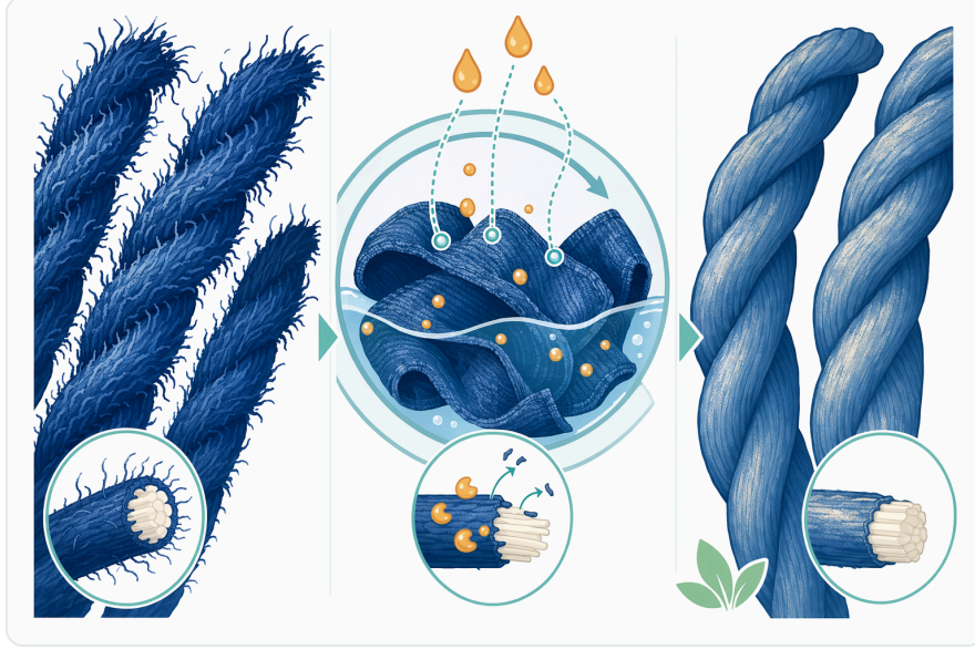
Figure 6. 데님과 면 마감 처리에서 산성 셀룰라아제는 처리 조건이 제어될 때 주로 노출된 표면 미세섬유에 작용한다.
