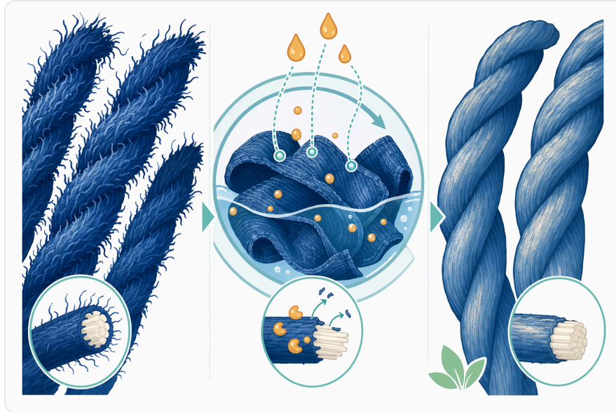
Figure 6. 데님과 면 마감 처리에서 산성 셀룰라아제는 처리가 제어될 경우 주로 노출된 표면 피브릴에 작용합니다.
