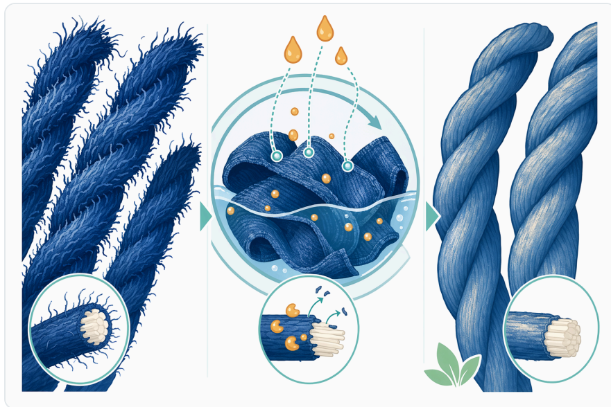
Figure 6. 데님과 면 마감 처리에서 공정을 적절히 제어하면 산성 셀룰라아제는 주로 노출된 표면 미세섬유에 작용합니다.
