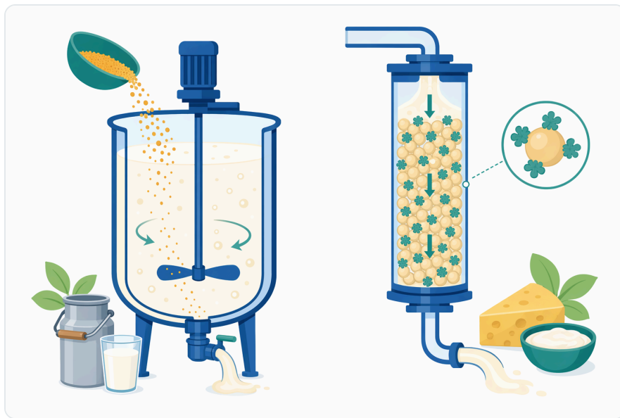
Figure 6. 可溶性乳糖酶粉末可直接添加使用，而固定化乳糖酶系統則將酵素保留在載體上，以便重複使用或進行連續式加工。
