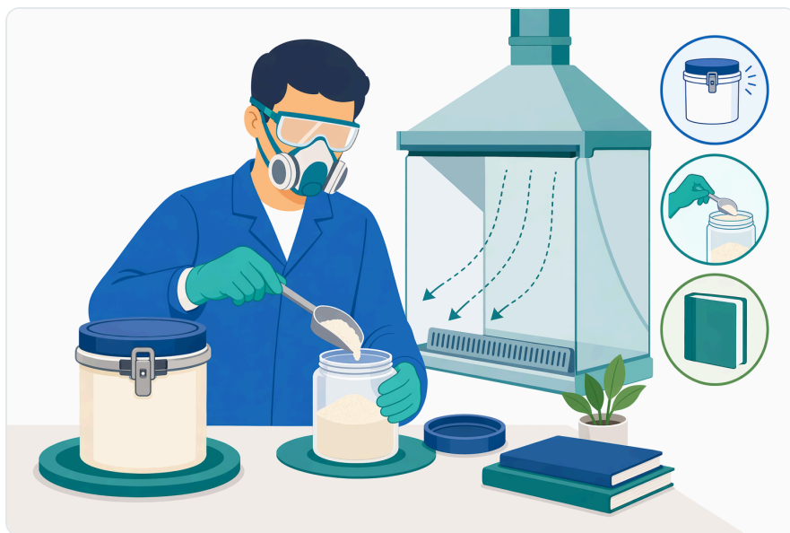
Figure 7. 處理粉末狀酵素製劑時，應盡量減少粉塵暴露，以及不必要的皮膚、眼睛或吸入接觸。
