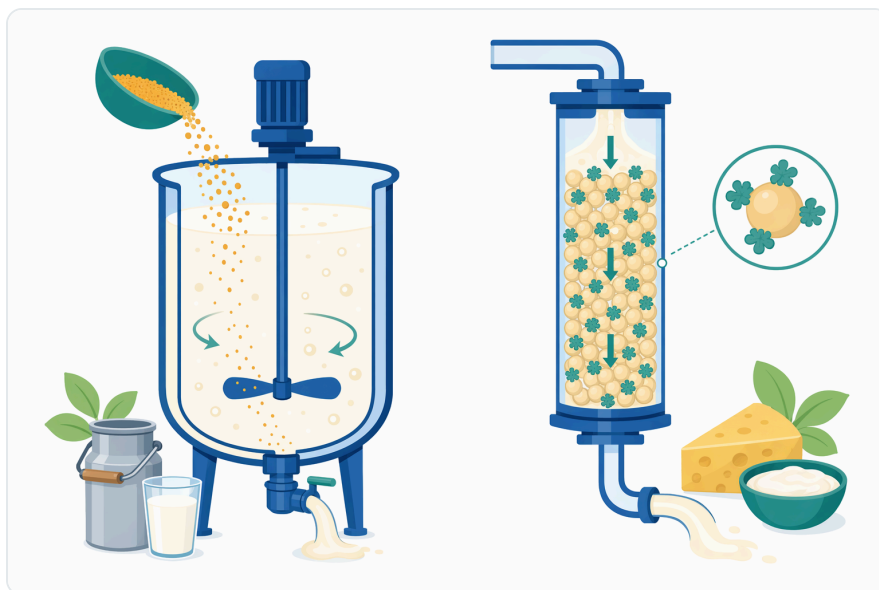
Figure 6. 분말형 가용성 락타아제는 직접 첨가하여 사용되는 반면, 고정화 락타아제 시스템은 효소를 지지체에 고정해 재사용하거나 연속 공정에 활용한다.
