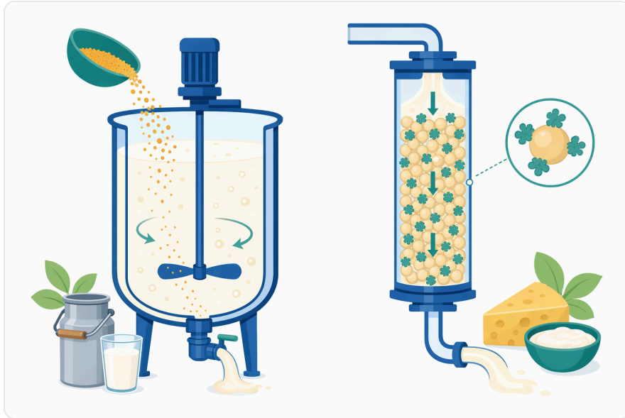
Figure 6. 분말 형태의 가용성 락타아제는 직접 첨가하여 사용되는 반면, 고정화 락타아제 시스템은 효소를 지지체에 고정해 재사용하거나 연속 공정에 활용한다.
