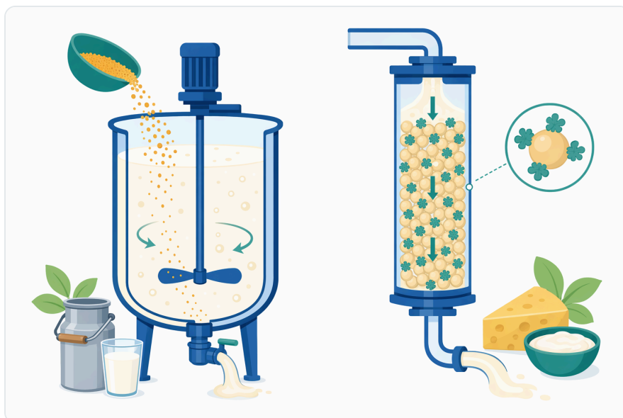
Figure 6. 분말 형태의 가용성 락타아제는 직접 첨가하여 사용하지만, 고정화 락타아제 시스템은 효소를 지지체에 고정해 재사용하거나 연속 공정에 활용합니다.
