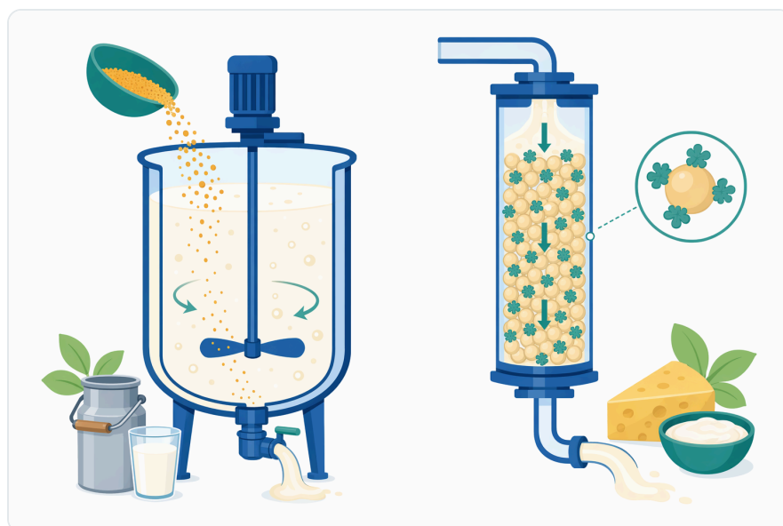
Figure 6. 수용성 락타아제 분말은 직접 첨가해 사용하지만, 고정화 락타아제 시스템은 효소를 지지체에 고정해 재사용하거나 연속 공정에 활용한다.
