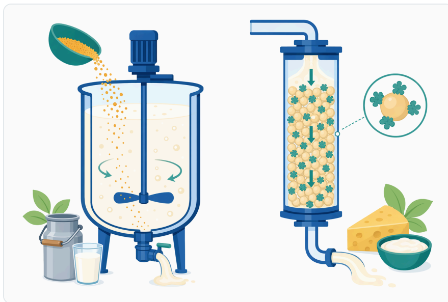
Figure 6. 분말 형태의 가용성 락타아제는 직접 첨가 방식으로 사용되는 반면, 고정화 락타아제 시스템은 효소를 지지체에 고정해 재사용하거나 연속 공정에 활용합니다.
