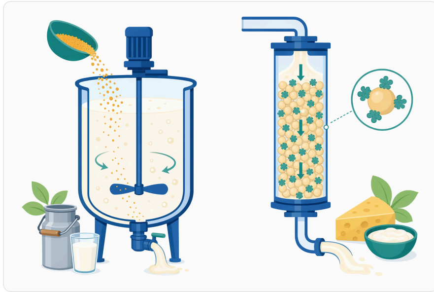
Figure 6. 가용성 락타아제 분말은 직접 첨가하여 사용되는 반면, 고정화 락타아제 시스템은 효소를 지지체에 고정해 재사용하거나 연속 공정에 활용합니다.
